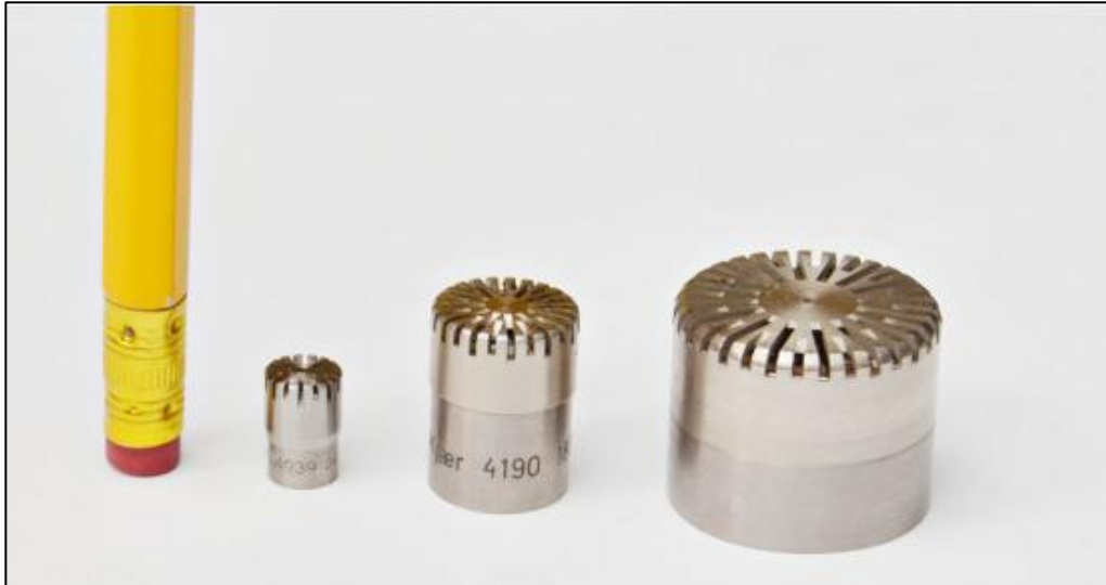
[איור 1: קפסולות המיקרופונים (מימין לשמאל): דגם 4145, דגם 4190 ודגם 4939. עפרון רגיל עבור קנה מידה]
